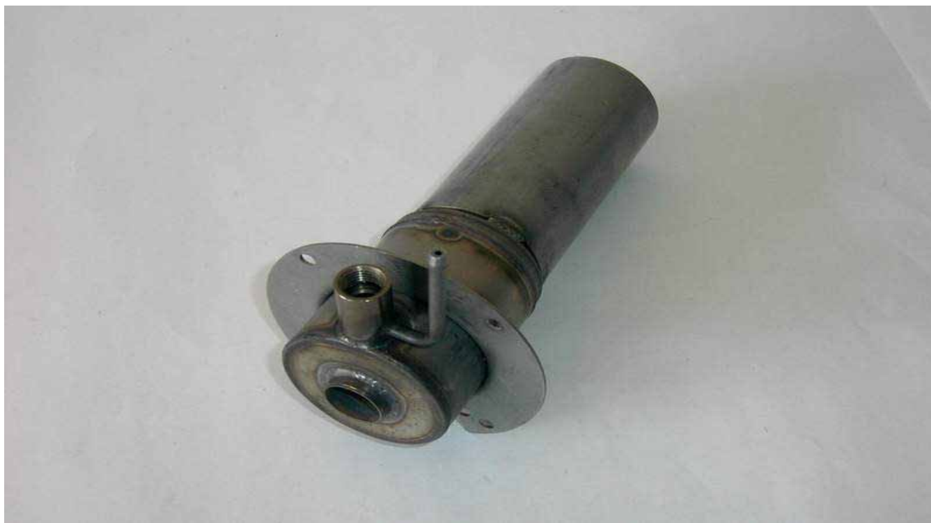
Рис.15 - Камера сгорания без завихрителя
